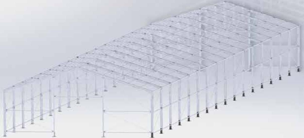
**3 /** Die Spannweite der Halle reicht von 10 bis 30 m, die Höhe von 3 bis 8 m, während die Länge der Halle für je 5 m definiert wird, was die Spannweite zwischen den tragenden Säulen/Segmenten ist
